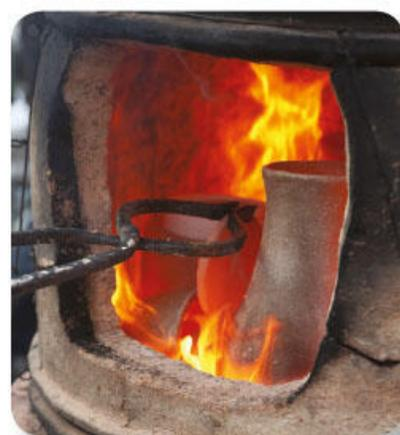
**Figura 1.36** Para fabricar una vasija de cerámica se cuece la mezcla de arcilla y agua en un horno a temperaturas mayores a 300 °C.
